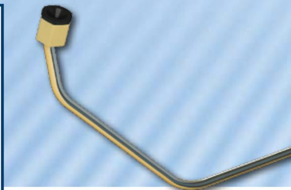
Os tubos de combustível que conduzem Diesel devem suportar a pressão máxima do sistema e suas oscilações de pressão.
